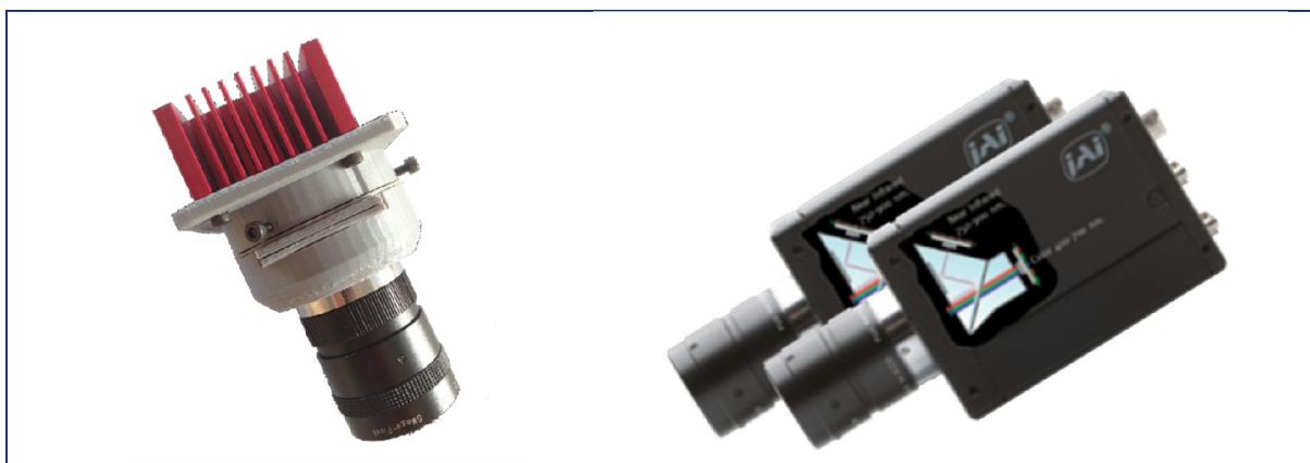
Figur 3.1: NIR projektor og to jAi kameraer i stereo setup
